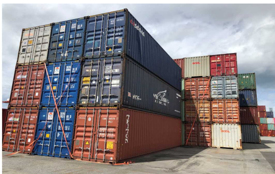
図表 9 空コンテナのラッシングベルトによる固定（博多港）
