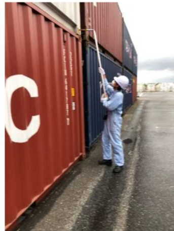
図表 8 固縛器具（ブーメラン）によるコンテナの固縛作業（博多港香椎パークポートコンテナターミナル）
