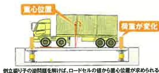
図41 偏荷重検知システム（左：前後左右方向、右：高さ方向）
