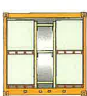
角材を使用した固定
