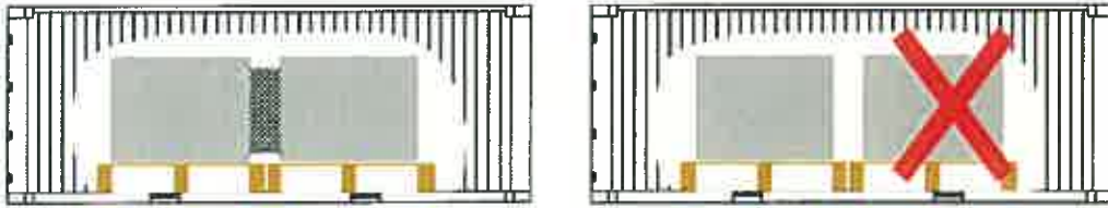
図24-5 積付の留意点（貨物の中のあいた空間には緩衝材を付ける（左））
