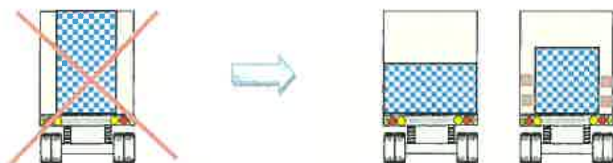
図 32 コンテナの積載量が荷物の重量で決まる場合
