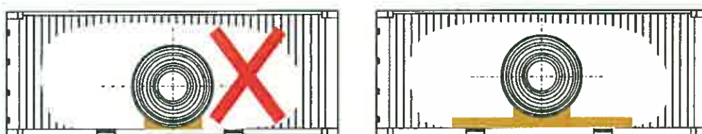
図24-1 積付の留意点（荷重を分散させる（右））
