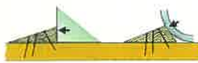
ウェッジを使用したローリング防止
