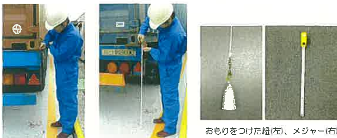
図 22 計測イメージと測定機材
