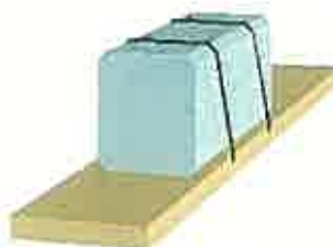
荷敷（スキッド）を使用した重量貨物の荷重分散
